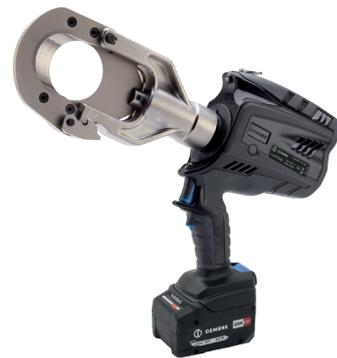
La taglierina oleodinamica a batteria B-TC650 con unità oleodinamica a doppio pistone serve per tagliare cavi telefonici, in rame e alluminio con un diametro fino a 65 mm. Grazie alla chiusura sulla testa il utensile può essere utilizzato per tagliare tanto materiale. Il buon maneggiamento è garantito grazie alla testa girevole di 335°.
