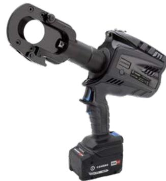
La taglierina oleodinamica a batteria B-TC500 con unità oleodinamica a doppio pistone serve per tagliare cavi telefonici, in rame e alluminio con un diametro fino a 50 mm (ad es. 4 x 150 mm<sup>2</sup> NYY-0). Grazie alla particolare affilatura e alla geometria speciale della lama di taglio è possibile garantire un taglio diritto. Grazie alla chiusura sulla testa il utensile può essere utilizzato per tagliare tanto materiale. Il buon maneggiamento è garantito grazie alla testa girevole di 90°.
