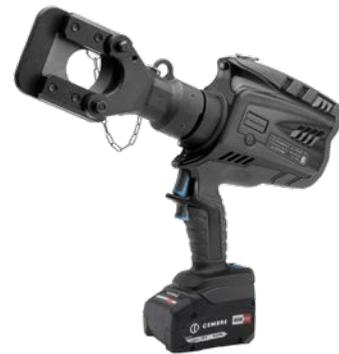
Das hydraulische Akkuschnidwerkzeug B-TC450 mit Doppelkolbenhydraulik, ist besonders geeignet zum Schneiden von massiven oder sehr harten Materialien bis zu einem maximalen Durchmesser von 45 mm. Durch den Klappverschluss am Schneidkopf kann das Werkzeug auch zum Schneiden von Endlosmaterial eingesetzt werden. Das Handling ist durch den um 180° drehbaren Kopf sehr gut gewährleistet.
