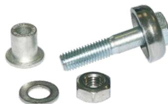
Un raccordement des rails de notre système est constitué de quatre pièces: - Douille de rivetage M12 en cuivre étamé- Vis hexagonale M12 A4 inoxydable (Contact simple avec entretoise)- Rondelle en acier inoxydable- Ecrou hexagonal M12 autobloquant en acier inoxydable A2
