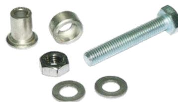
Un raccordement des rails de notre système est constitué de quatre pièces: - Douille de rivetage M10 en cuivre étamé- Vis hexagonale M10 A4 inoxydable (Contact simple avec entretoise)- 2 rondelles en acier inoxydable- Ecrou hexagonal M10 autobloquant en acier inoxydable A2
