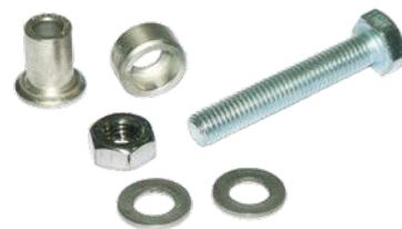
Un raccordement des rails de notre système est constitué de quatre pièces: - Douille de rivetage M12 en cuivre étamé- Vis hexagonale M12 A4 inoxydable (Contact simple avec entretoise)- 2 rondelles en acier inoxydable- Ecrou hexagonal M12 autobloquant en acier inoxydable A2
