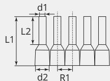
**DIMENSIONI****d1 (Ø):** 2.3**d2 (Ø):** 4.2**L1 (mm):** 14.5**L2 (mm):** 8.0**R1 (mm):** 5
