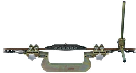
Mit dem Werkzeug AD-GW wird die Montage sehr vereinfacht und die Montagezeit von Fahrdrabtstossklemmen auf Rillenfahrdrähten verkürzt. Das Werkzeug wird in den bereits vorhandenen Hubzug mit seinen Fahrdrabtzugklemmen integriert.
