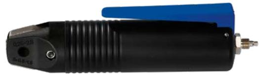
Mit den pneumatischen Crimpern lassen sich Aderendhülsen schnell und ermüdungsfrei verpressen. Der AC-40 ist leicht und handlich und eignet sich dadurch hervorragend für den Schaltschrankbau. Die Geräte sind wartungsfrei. Ein Druck von 4 bis 6 bar gewährleistet eine sichere Verpressung. Durch das stabile Polyamid-Gehäuse sind sie jedem rauen Industrieinsatz gewachsen.
