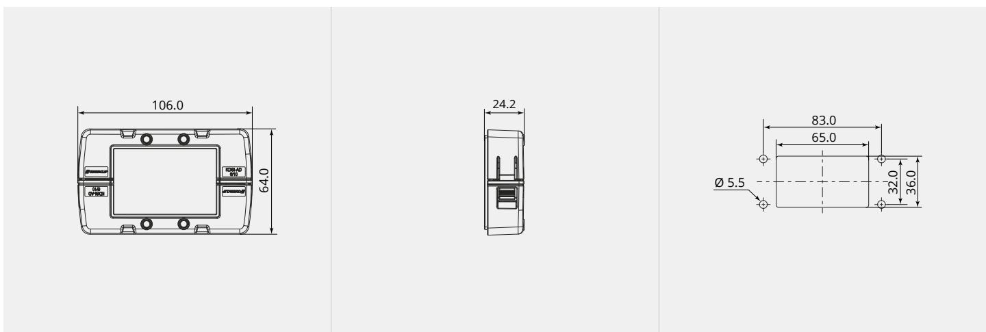
**DIMENSIONI****Larghezza (mm):** 64**Altezza (mm):** 24.2**Altezza di installazione (mm):** 24.2**Lunghezza (mm):** 106**Larghezza di taglio (mm):** 36**Lunghezza di taglio (mm):** 65**Ø vite (mm):** 5.5
